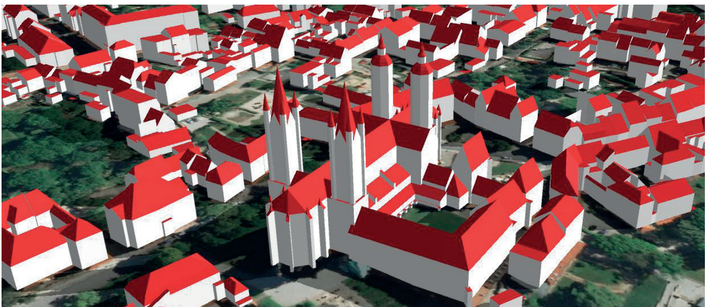
LoD2: 3D-Modell der Außenhülle und Dachstrukturen (Abb.: Naumburger Dom)
