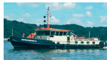
Tiefenprofilaufnahme auf Wasserstraßen mit HEPS
